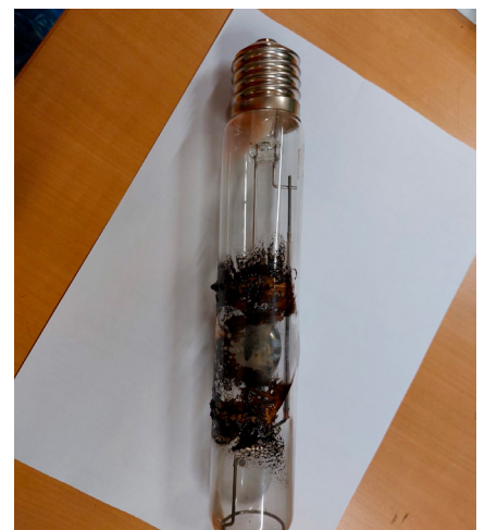
De lamp uit het ongeval. De resten van de gesmolten vod zijn nog aanwezig.
