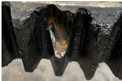
Foto 2: afgebroken tand draaikrans
