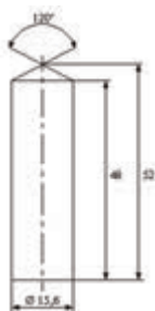
Afb. 2 : Cilindervormige bronzen zuiger (afmetingen in mm)
