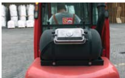
Heftruck met vast gemonteerde LPG-tank
