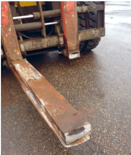
Foto 1: heftruck met afgebroken lip
