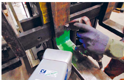
Foto 2: magnetisch onderzoek op heftruckvork
