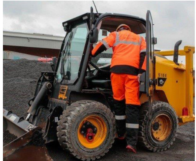
Bobcat met toegang aan de zijkant.
