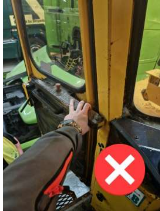
Simulatie van het ongeval: de hand ligt op het scharnier.
