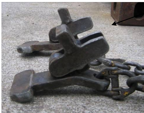
Containerhaak, schuine belasting
