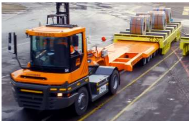
Figuur 3: trekker-translifter combinatie met cassette
