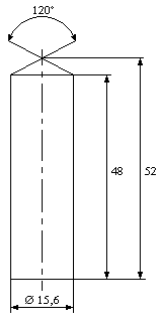
Afb. 2 : Cilindervormige bronzen zuiger (afmetingen in mm)
