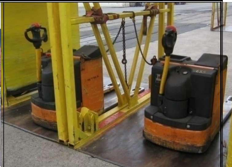
5. Draai de besturingsarm zodat de wielen dwars komen te staan
