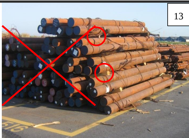
Gebroken beddingplanken tussen de lagen
