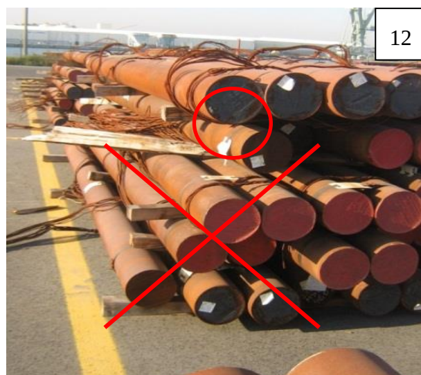
Steel bars niet volledig ondersteund door bedding
