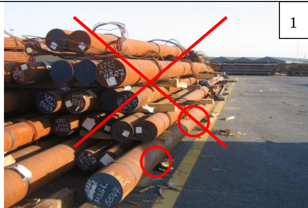
Beddingplanken onvoldoende lang
