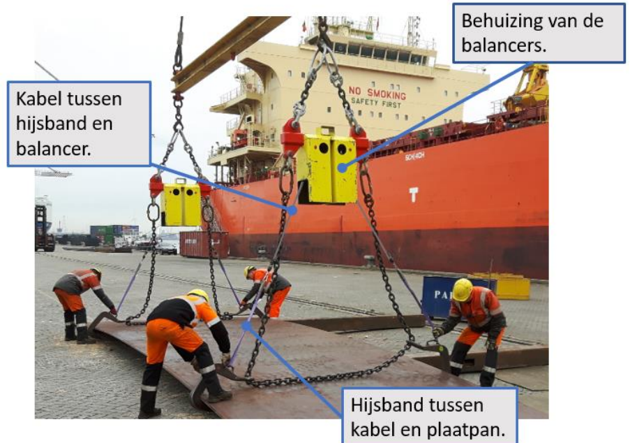
Foto 2: voorbeeld van ophanging balancers in een behuizing.
