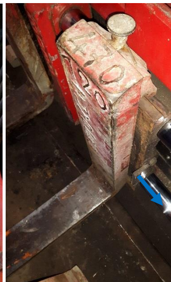
Foto 8: shiftbeweging om vork van vorkdrager te schuiven
